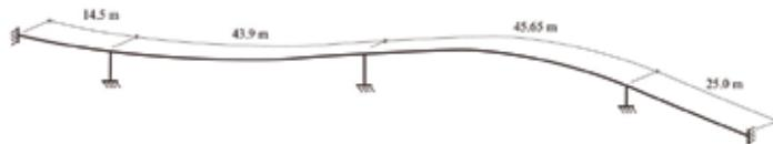
Pour le pré-dimensionnement de la passerelle, les piliers et les culées ont été entièrement ancrés dans le sol de fondation. Il en résulte des valeurs conservatrices pour leur charge. Les actions permanentes telles que le poids propre et la surcharge, ainsi que les actions variables telles que la charge du trafic et les variations de température ont été prises en compte.
